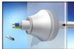
Duw de kabel door de sluiting
